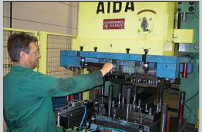
Spänns och säkras endast med ett ¼ varv Locked and secure only with a ¼ turn Gespannt und gesichert mit einer ¼ Umdrehung
