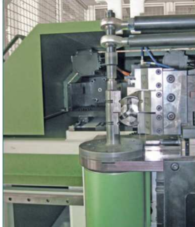
Všechny osy dvouhlavého ohýbacího stroje jsou poháněné a řízené servomotory. Pouze tímto je možné dosáhnout velice úzké ohýbací poloměry až 1 x D.
