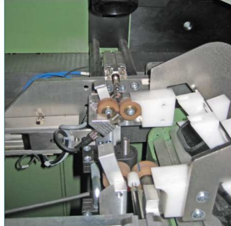
Rozpoznání svaru: Na kartáčované svařované trubce není z vnější strany skoro patrný svar. Toto novátorské optické rozpoznání svaru je založeno na principu krátkého přisvětlení vnitřního pláště trubky.
