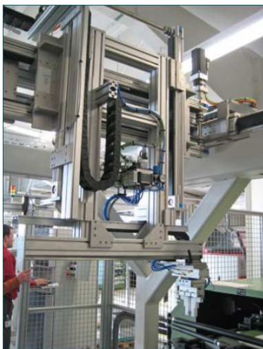
Manipulační systém je na masivním v zemi ukotveném rámu a dosahuje zrychlení až 6 m/s 2 .
