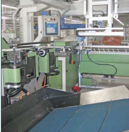
Pohled do ohýbací jednotky s dvouhlavým ohýbacím strojem (vlevo) a zásobníkem včetně zpracování koců trubek a zařízení na rozpoznávání svaru v pozadí.
